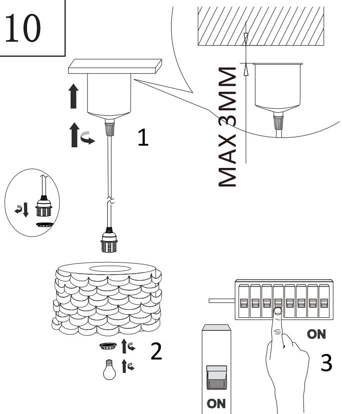
Remplacer immédiatement les lampes hors d'usage par des lampes du même type que celles fournies ou d'un type préconisé par le fabricant. Veuillez débrancher le luminaire de l'alimentation électrique et attendre que l'ampoule ait refroidie. Conformez-vous au dessin explicatif de la notice lors du changement de l'ampoule.
