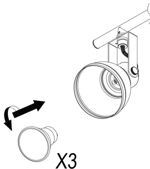
Remplacer immédiatement les lampes hors d'usage par des lampes du même type que celles fournies ou d'un type préconisé par le fabricant. Veuillez débrancher le luminaire de l'alimentation électrique et attendre que l'ampoule ait refroidi. Remplacez l'ampoule usagée par une ampoule neuve ayant les mêmes caractéristiques que celles indiquées sur la notice. Pour cela, conformez-vous au dessin du changement de l'ampoule.
