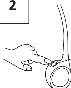
Variateur d'intensité de la lampe / 3 niveaux d'intensité : 100% luminosité, 60% luminosité, 20% luminosité, OFF.
