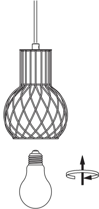
Remplacer immédiatement les lampes hors d'usage par des lampes du même type que celles fournies ou d'un type préconisé par le fabricant. Veuillez débrancher le luminaire de l'alimentation électrique et attendre que l'ampoule ait refroidie. Conformez-vous au dessin explicatif de la notice lors du changement de l'ampoule.
