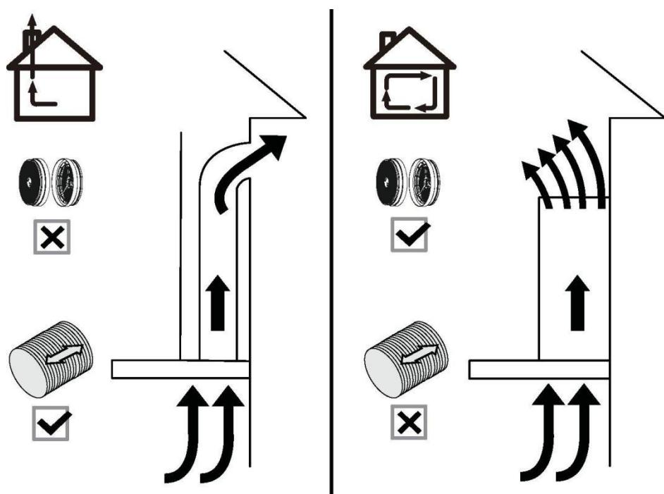
b) Utilisez au moins 60cm de tuyaux d'évacuation direct avant tout virage lorsque c'est possible. Plus de travaux de conduits seraient nécessaires pour de meilleures performances avec des conduits plus longs.
