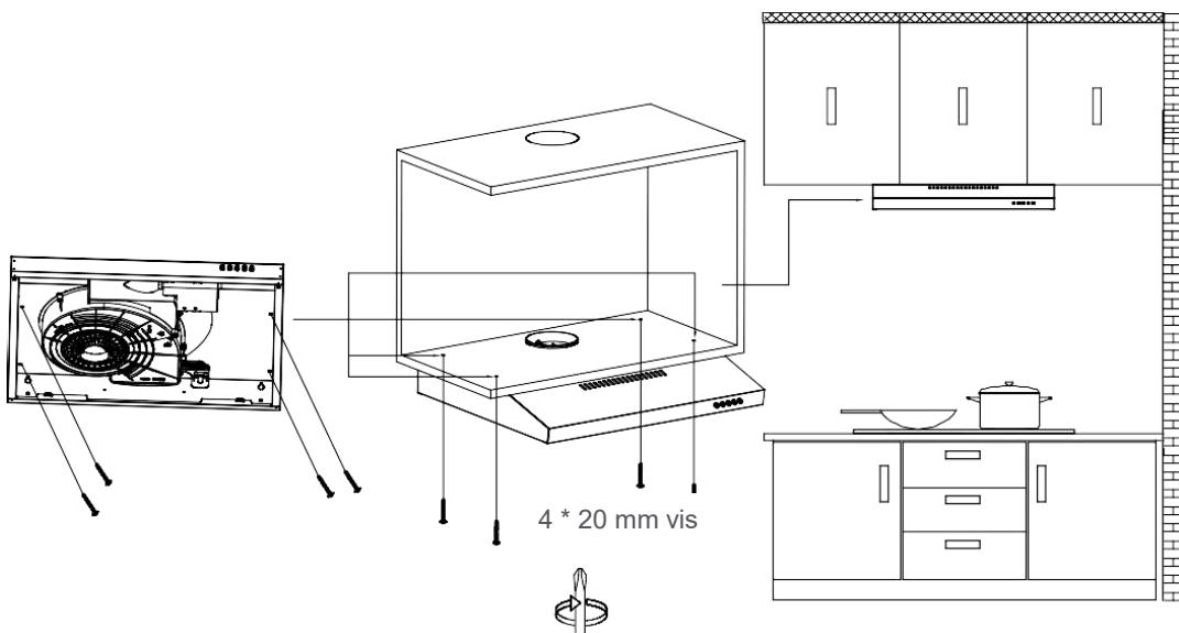
5) Installez le déflecteur d'air et remettez le filtre à graisse sur la hotte.
