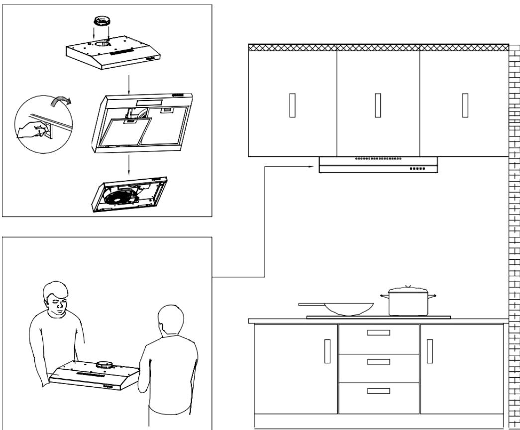
4) Alignez la bouche d'aération de la hotte avec le trou de l'armoire en bas, faites passer le cordon d'alimentation par le trou d'alimentation, puis utilisez les quatre vis 4 \* 20 mm pour fixer la hotte dans la position correspondante.
