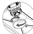
**C** Après nettoyage, le filtre à cylindre doit être assemblé dans le sens des aiguilles d'une montre jusqu'à la marque triangulaire du filtre, en même temps que le filet filtrant en l'acier inoxydable.
