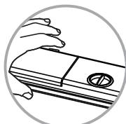
1. Appuyez sur le trappe convexe poudre de détergent / chargeur de comprimés
