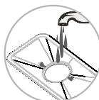
**A** Utilisez de l'eau courante pour rincer le filtre. N'utilisez pas de brosse en fer ou en laine d'acier, cela causera la rouille du filtre.
