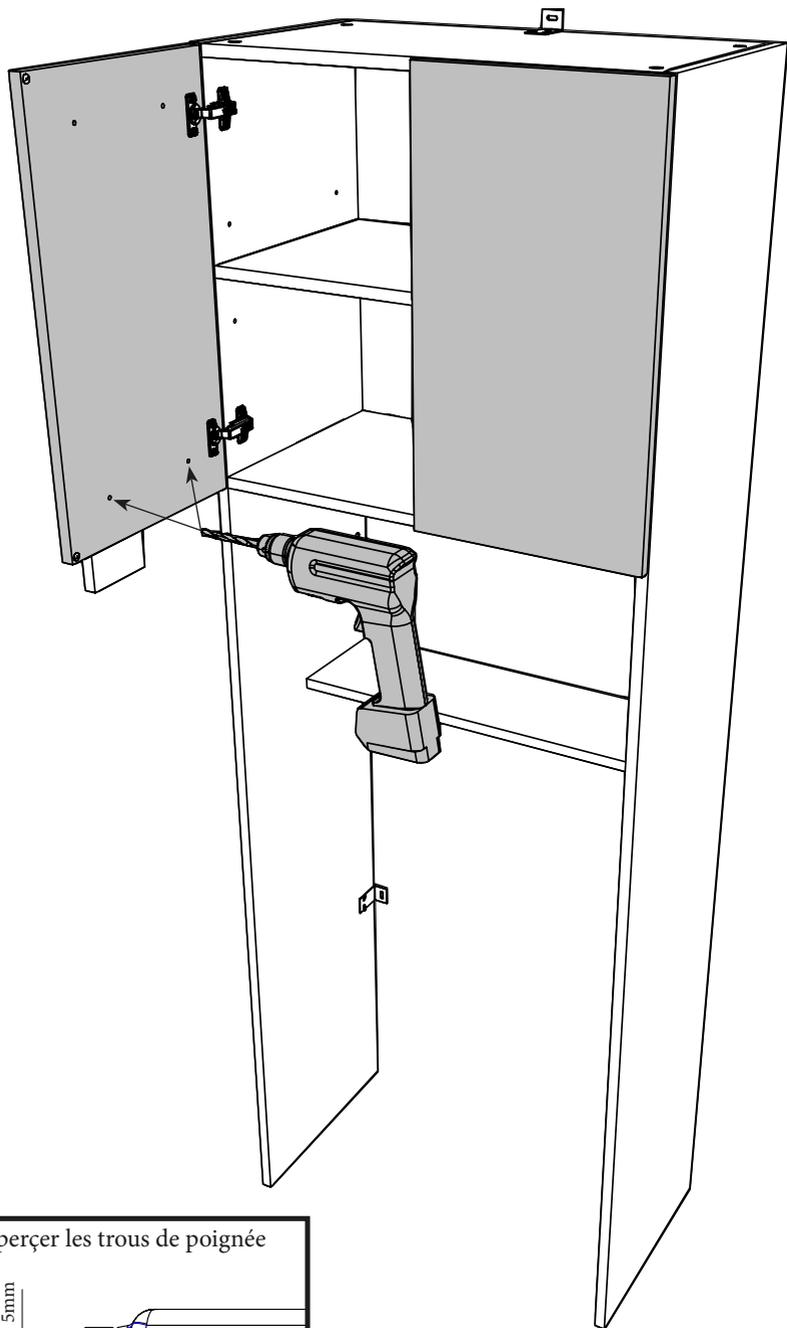
Utiliser une cale pour percer les trous de poignée
