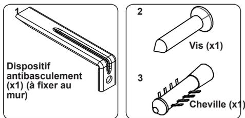
Le sac de documentation contient un kit antibasculement. Fixer le dispositif antibasculement (1) sur le mur à l'aide de la vis (2) et de la cheville (3), conformément aux dimensions de l'illustration et du tableau ci-dessous. Régler la hauteur du dispositif antibasculement pour l'aligner sur la rainure de la cuisinière, puis serrer la vis (2). Pousser l'appareil vers le mur en s'assurant que le dispositif antibasculement est inséré dans la rainure à l'arrière de l'appareil.
