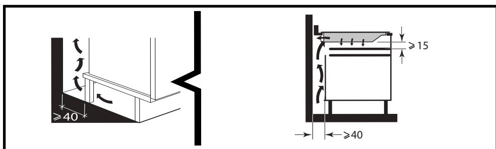
ou au-dessus d'un four encastrable , respectez les dimensions notées sur les illustrations afin d'assurer une sortie d'air suffisante à l'avant. Collez soigneusement le joint d'étanchéité sur tout le pourtour du verre de la table et introduisez la table dans le meuble.
