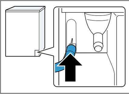
3. Poussez le tuyau d'évacuation d'eau sur le manchon jusqu'en butée.
