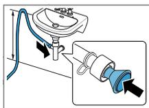
Fixez le point de raccordement avec un collier de serrage (12-22 mm). Fixez le tuyau d'évacuation d'eau avec un guide de flexible à une hauteur minimale de 80 cm et maximale de 100 cm.
