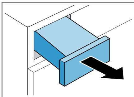
2. Vider le réservoir d'eau de condensation.
