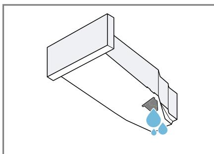
Veuillez à insérer le réservoir d'eau de condensation avant d'utiliser l'appareil. → Page 31
