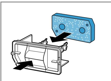
Veuillez à ne pas déformer, endommager ni faire glisser latéralement le matelas filtrant nettoyé sur les supports.
