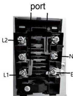
3, 380V-415V 3N ~: Caractéristiques du cordon d'alimentation: diamètre du fil 5G 2,5 mm<sup>2</sup> au minimum; type de cordon: H05RR-F, H05RN-F, H07RN-F. La méthode de ports métalliques doivent être connectés comme représenté ci-dessous:
