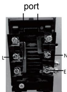
2, 380V-415V 2N ~: Caractéristiques du cordon d'alimentation: diamètre du fil 4G 4,0 mm<sup>2</sup> au minimum; type de cordon: H05RR-F, H05RN-F, H07RN-F. La méthode de connexion de ports métalliques doivent être connectés comme représenté ci-dessous:
