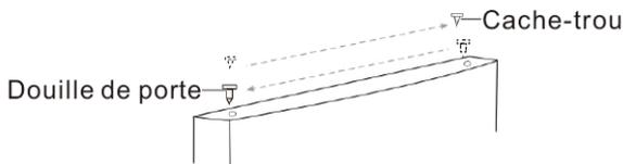
13. Retirez les cache-trous de la charnière centrale sur le côté gauche de l'appareil, puis insérez-les dans les trous de vis sur la droite du corps de l'appareil.
