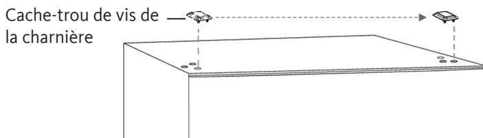
19. Fixez la charnière supérieure en haut à gauche du corps de l'appareil à l'aide des vis que vous avez retirées précédemment. Avant de resserrer les vis de la charnière supérieure, assurez-vous que le haut de la porte est bien au même niveau que le corps de l'appareil et que le joint en caoutchouc est bien hermétique.
