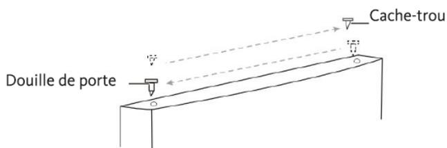
18. Retirez la vis qui maintiennent le cache-trou de la charnière en haut à gauche du corps de l'appareil, retirez le cache et fixez-le en haut à droite de l'appareil.
