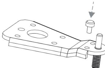
9. Installez la charnière centrale sur le côté gauche du corps de l'appareil.
