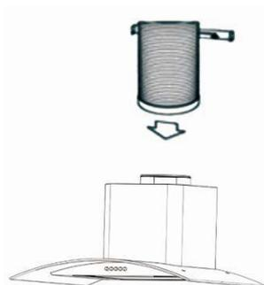
Un ruban adhésif et une ficelle en plastique sont fournis pour fixer le tuyau en aluminium.
