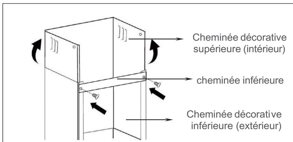
Installez la cheminée sur la hotte. Fixez le support de la cheminée inférieure sur le mur avec 2 vis (4mmx30mm).
