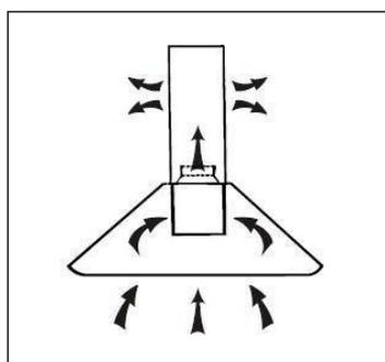
Le filtre à charbon actif peut être utilisé pour absorber les odeurs.
