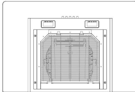
**Remarque:** Assurez-vous que le filtre soit fixé fermement. Si ce n'est pas le cas, il pourrait se relâcher et provoquer des dangers. Lorsque le filtre à charbon actif est installé dans l'unité, la puissance d'aspiration sera diminuée.
