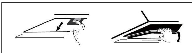
Installez le filtre à charbon: La partie A du filtre à charbon doit être insérée à l'arrière, et la partie B doit être insérée à l'avant.
