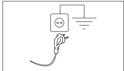
Une fois l'appareil installé, assurez-vous que le câble d'alimentation est facilement accessible.
