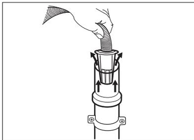
4. À une conduite fixe dotée d'une ventilation spéciale : insérez directement le tuyau dans la conduite d'évacuation. Reportez-vous à l'illustration.
