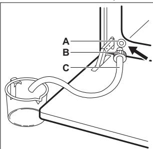
3. Maintenez l'extrémité du tuyau au-dessous du niveau **A** et appuyez à plusieurs reprises sur **B** pour récupérer l'eau résiduelle.
