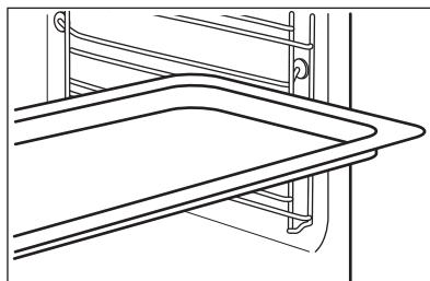
Poussez la plaque entre les rails du support de grille. Placez la plaque de cuisson avec la pente vers l'arrière de l'intérieur du four.
