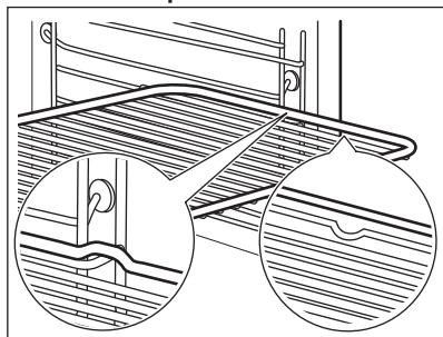
Insérez la grille entre les barres de guidage des supports de grille et assurez-vous que les pieds sont orientés vers le bas. Assurez-vous que la grille touche l'arrière de l'intérieur du four.
