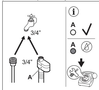
5. Raccordez l'autre extrémité du tuyau d'arrivée d'eau FROIDE à un robinet d'eau froide fileté (3/4 pouce).
