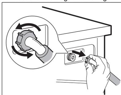
3. Utilisez une brosse à dents pour nettoyer le filtre de la vanne situé à l'arrière de l'appareil.
