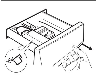
2. Retirez le bac. Appuyez sur la position avec le (PUSH) pour retirer facilement le bac.
