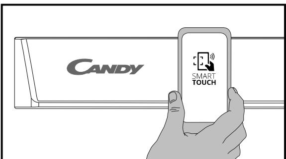
Si vous ne savez pas où se situe l'antenne NFC sur votre Smartphone, faites de lents mouvements circulaires autour du logo Smart Touch jusqu'à ce que l'application Candy simply-Fi confirme la connexion. Afin de garantir une connexion stable, il est important de GARDER LE SMARTPHONE SUR LOGO Smart Touch PENDANT LA PROCÉDURE D'APPARIAGE ET PENDANT LES PHASES DE SYNCHRONISATION. L'application simply-Fi vous avertira lorsque vous pourrez retirer votre Smartphone du logo Smart Touch.
