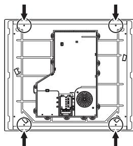
2. Vissez les pattes de fixation (A) dans les trous indiqués au moyen des vis enlevées précédemment pour fixer correctement la plaque de cuisson à la structure.
