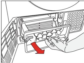
4. Nettoyez le condenseur en appliquant de l'eau sous pression à l'aide d'une armature de douche et attendez que l'eau s'écoule.
