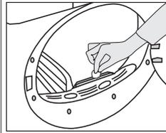
Votre machine est équipée de capteurs d'humidité qui détectent si le linge est sec ou non. Pour nettoyer le capteur :
