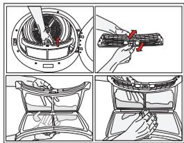
Ouvrez la porte de chargement. Retirez le filtre de trappe en tirant dessus, puis ouvrez le filtre.
