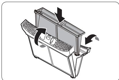
5. Placez le filtre intérieur dans le filtre extérieur, puis réinsérer le filtre à peluches dans sa position d'origine.
