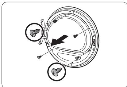
3. Retirez les 3 vis supérieures et les 3 vis inférieures sur le dispositif de fixation du verre puis retirez ce dernier.
