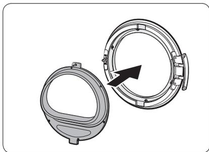
5. Insérez le dispositif de fixation du verre dans la nouvelle position du cache du hublot. Assurez-vous que la charnière du hublot est dans la même position, comme indiqué sur l'illustration.
