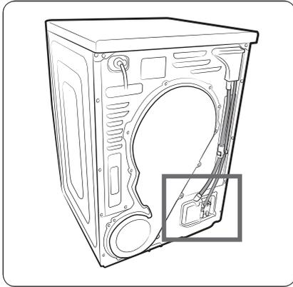
Le sèche-linge est équipé d'un réservoir d'eau intégré. Toutefois, si vous ne souhaitez pas utiliser le réservoir d'eau, vous pouvez installer le tuyau de vidange. Le tuyau en option fourni (long tuyau de vidange) peut être utilisé en tant que rallonge du tuyau de vidange.
