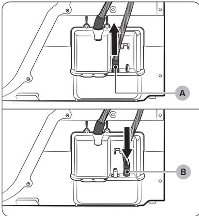
1. Retirez le tuyau de vidange au niveau de l'orifice (A) et insérez-le dans l'orifice (B).
