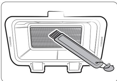
4. Nettoyez l'échangeur de chaleur à l'aide de la brosse de nettoyage fournie ou d'un aspirateur équipé d'un accessoire brosse. Veillez à ne pas plier ou endommager les ailettes de l'échangeur de chaleur lors du nettoyage. Cela risquerait de réduire les performances de séchage.
