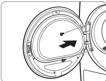
12. Placez la charnière du hublot sur le côté opposé puis serrez les 2 vis pour fixer le hublot sur le sèche-linge.
