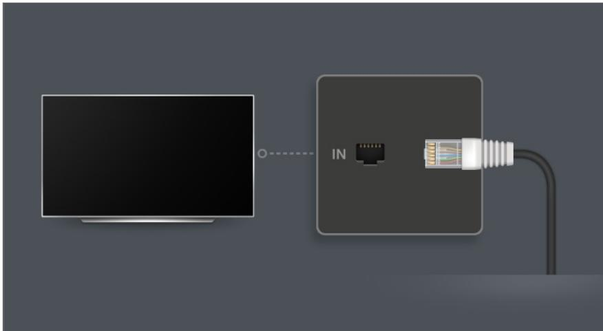
01 Connectez le port LAN du téléviseur et le routeur à l'aide d'un câble LAN. Le routeur doit être préalablement connecté à Internet.
