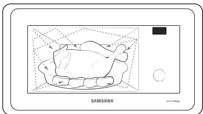
1. Les micro-ondes générées par le magnétron sont réfléchies sur les parois du four et réparties de façon homogène à l'intérieur du four pendant la cuisson grâce à la rotation du plateau tournant sur lequel sont placés les aliments. Ce procédé assure donc une cuisson homogène.
