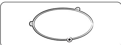
**01 Anneau de guidage**, à placer au centre du plancher du four.
