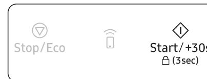
Appuyez sur le bouton **Start/+30s (Démarrage/+30s)** et réglez la durée sur 4 ou 5 minutes en appuyant sur le bouton **Start/+30s (Démarrage/+30s)** autant de fois que nécessaire.
