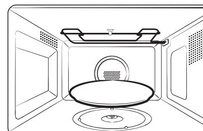
1. Placez le plat croustilleur directement sur le plateau tournant. Préchauffez-le en utilisant le mode combiné micro-ondes et gril le plus élevé [600 W + gril] en respectant le temps et les indications figurant dans le tableau.
