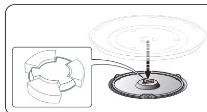
Retirez tout élément d'emballage de l'intérieur du four. Installez l'anneau de guidage et le plateau tournant. Vérifiez que le plateau tournant tourne librement.
